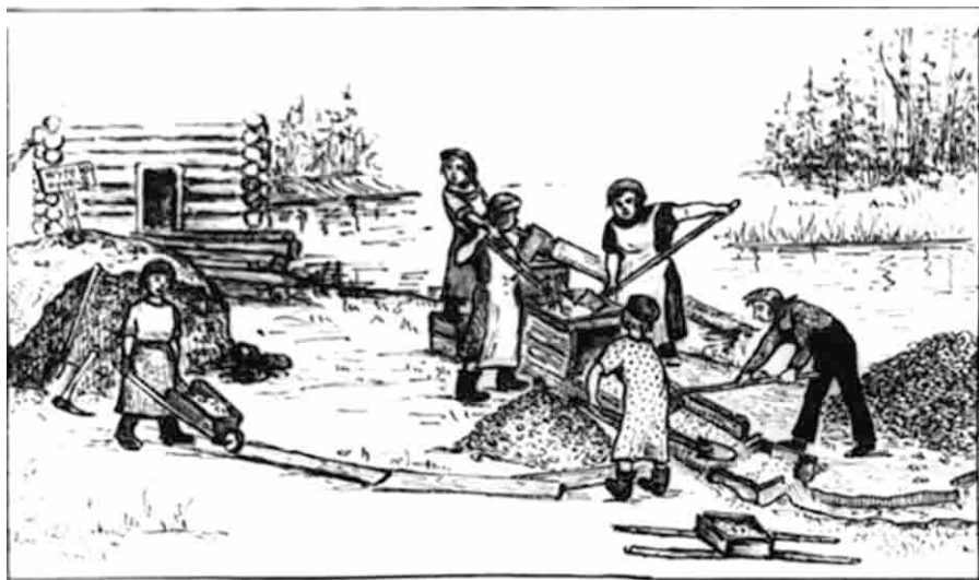
Медведкинская россыпь. Промывка алмазоносных "песков" вручную - на ваяхгерде. Берег р. Кайгы, июнь 1944 г.
