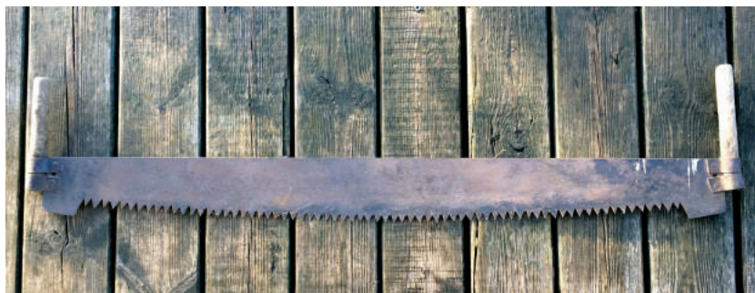
Двуручная пила для поперечной распиловки брёвен
