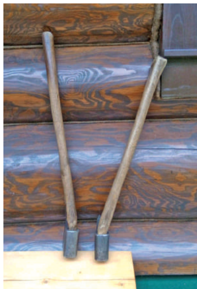
Топоры с изогнутой ручкой для отески стен в готовом срубе
