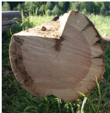
Заболонь со временем разрушается, а ядро по-прежнему крепкое
