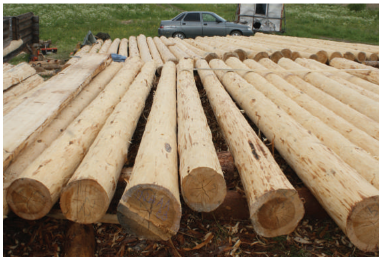
Просушка окоренного леса на подкладках. На свежих бревнах хорошо видна величина ядра
