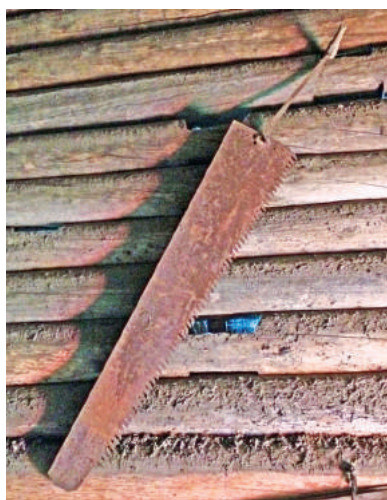
Пи́ла для продольной распиловки брёвен
