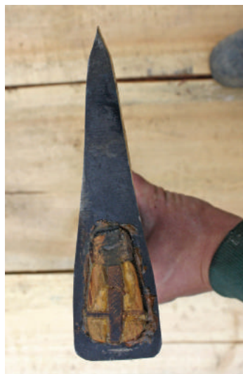
Заточка колунообразного топора
