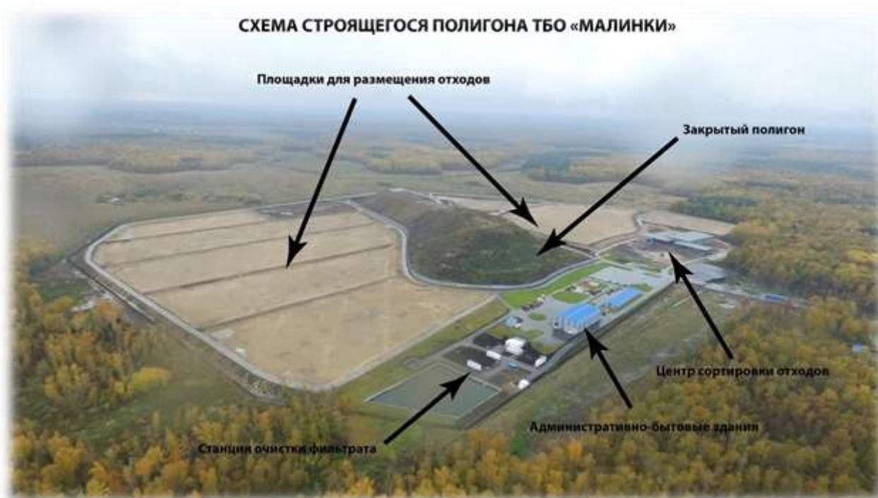
*Рис. 50 Схема полигона «Малинки»*
