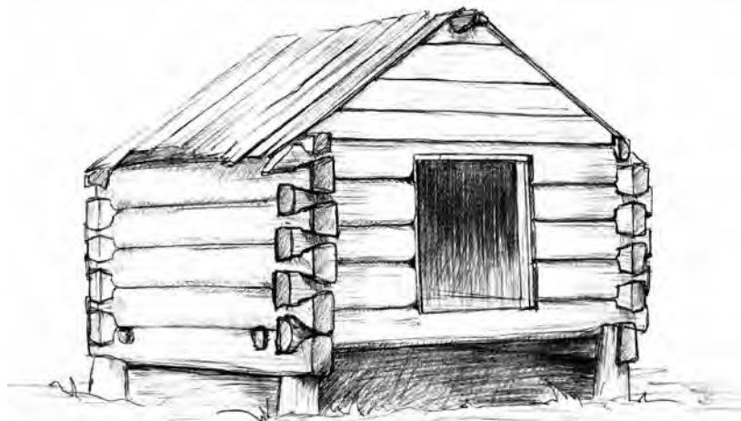
Рис. 21. «Косая лапа» с остатком. Рыбный амбар в д. Чапома, Терский район, Мурманская область
