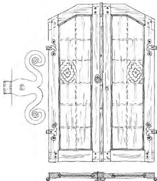
Рис. 19. Филенчатая дверь XVIII века из собрания Государственного Исторического музея в Москве. Вид с наружной стороны, план. «Лапчатая» петля.
