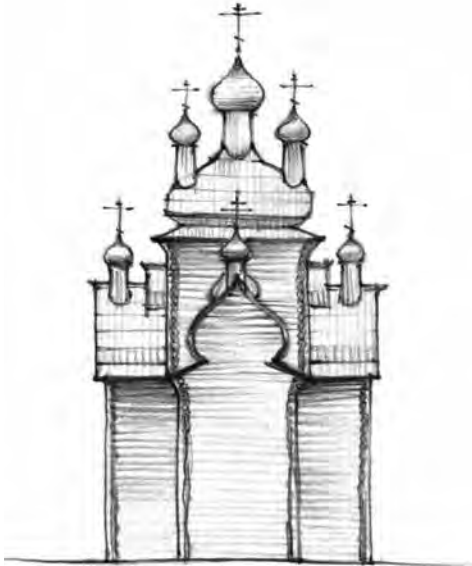
Рис. 18. Пример постановки широкого четверика на крещатое основание. Преображенская церковь 1678 года в селе Чекуево
