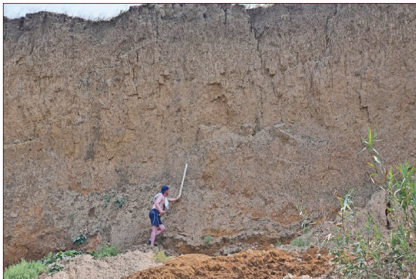
Рис. 10. Толща плейстоценовых и голоценовых отложений, обнажившаяся в результате схода крупного оползня в береговом обрыве в районе поселения Кротки. В нижней части снимка виден фрагмент тела оползня, который продолжает смещаться по водонасыщенному песчано-глинистому горизонту. В верхней части разреза отчетливо виден почвенный слой. Кроме того, верхняя часть разреза нарушена кротовинами и небольшими современными эрозионными врезам, сформированными сезонными потоками воды
