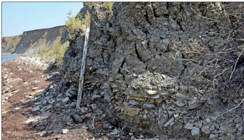
Рис. 33. Средняя Тузла. Тело активного оползня, спустившегося до уреза воды. Породы насыщены водой, поступающей по слоям коллекторам. В подошве оползневого тела хорошо видны захороненные современные пляжевые отложения, в том числе и антропогенного происхождения
