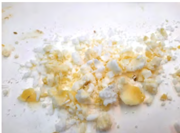
Рис. 11. Процесс удаления сухого аэросила с адсорбированным воском с поверхности образца
