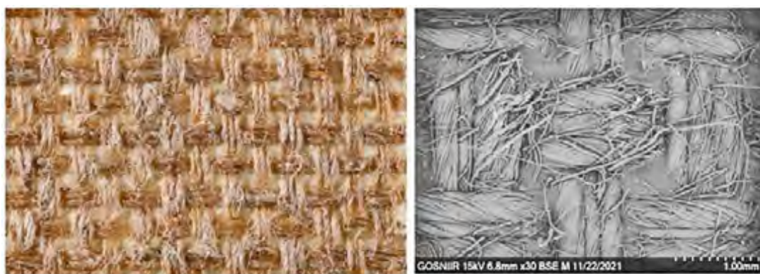
Рис. 19. Удаление воско-смоляного состава при помощи очищенного бензина. Макроснимок в видимом диапазоне и СЭМ-изображение структуры холста
