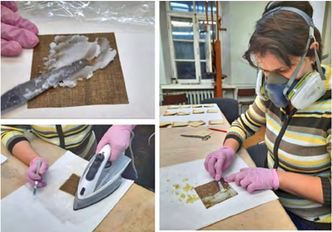
Рис. 10. Нанесение пасты на основе аэросила на холст. Проглаживание образца утюгом после 15-минутной экспозиции
