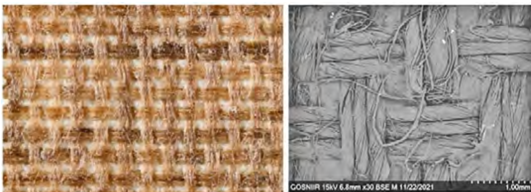
Рис. 18. Удаление воско-смоляного состава методом нагрева. Макроснимок в видимом диапазоне и СЭМ-изображение структуры холста
