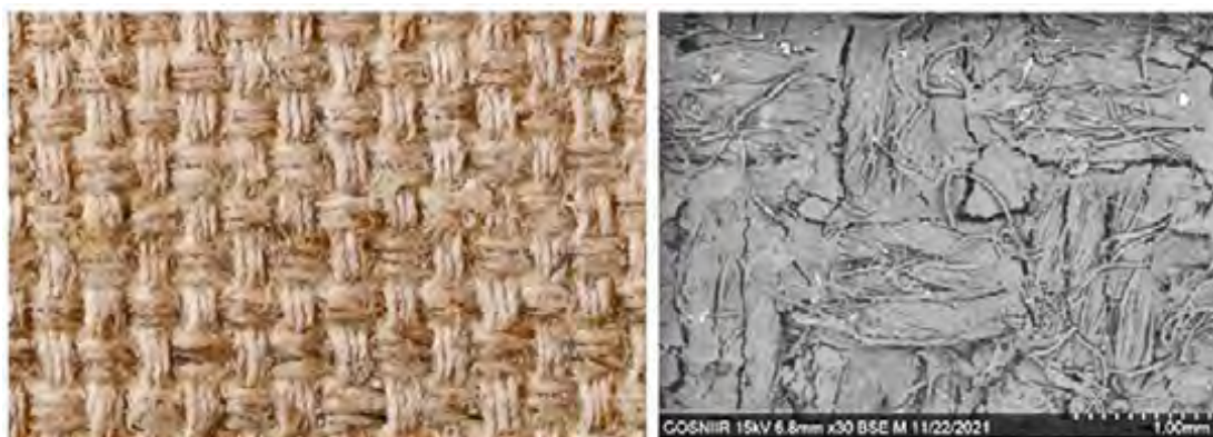
Рис. 21. Удаление воско-смоляного состава при помощи пасты из аэросила. Макроснимок в видимом диапазоне и СЭМ-изображение структуры холста
