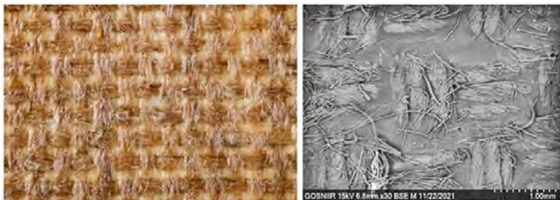
Рис. 20. Удаление воско-смоляного состава компрессами из гидроксипропилцеллюлозы. Макроснимок в видимом диапазоне и СЭМ-изображение структуры холста
