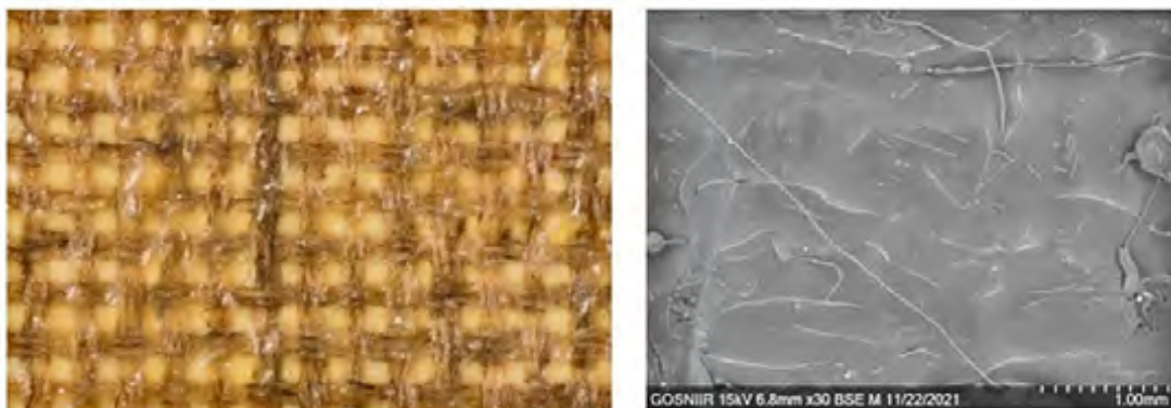
Рис 17. Холст, пропитанный воско-смоляным адгезивом. Макроснимок в видимом диапазоне и СЭМ-изображение структуры холста
