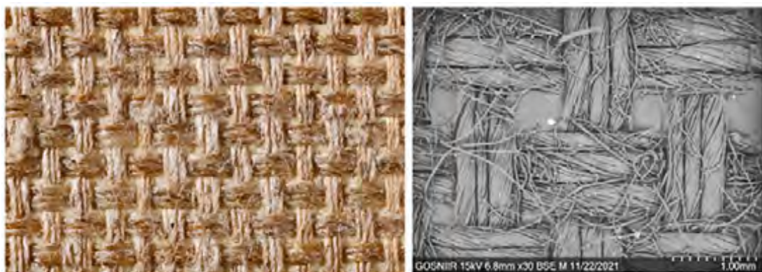
Рис. 22. Удаление воско-смоляного состава на Evolon CR с помощью вакуумного стола. Макроснимок в видимом диапазоне и СЭМ-изображение структуры холста
