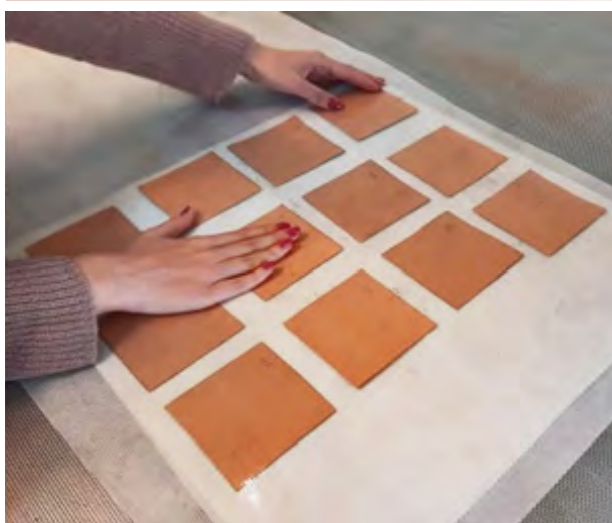
Рис. 12. Пропитка ткани Evolon CR ксилолом и подготовка образцов для работы на столе низкого давления
