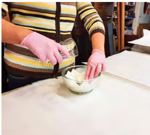
Рис. 11. Процесс удаления сухого аэросила с адсорбированным воском с поверхности образца
