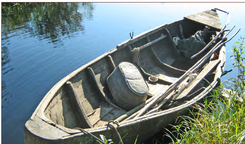
Илл. 16. Лодка Чудского озера, шитая «вгладь» с ластом. Фото автора, 2008 г.
