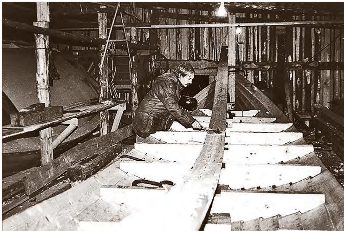
Илл. 5. Перед тем как «ставить» обшивочные доски, их пропитывали горячей олифой. Правда, нам рекомендовали пустить в ход топленый тюлений жир. Но где же взять этих тюленей? Фото А. Епатко, 1997 г.
