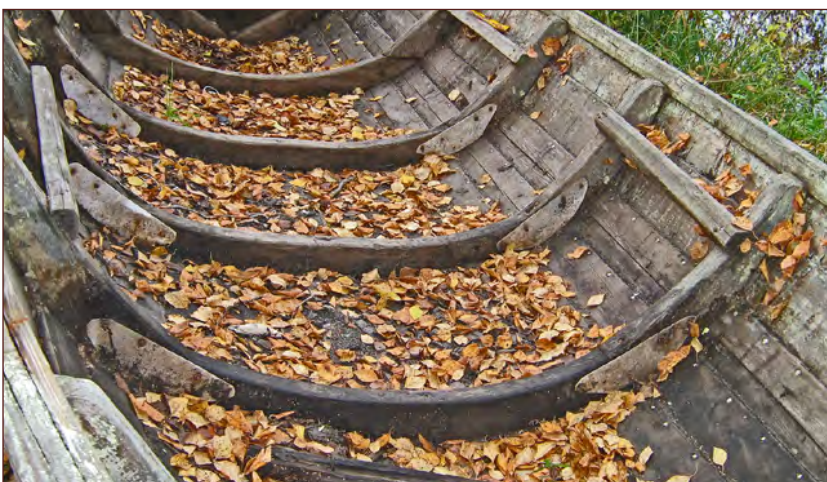
Илл. 18–19. Шпангоуты в корпусе лодки. Фото автора, 2004 г.
