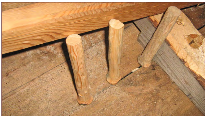
Илл. 4. Деревянные нагель для крепления шпангоутов. Фото автора. 2008 г.
