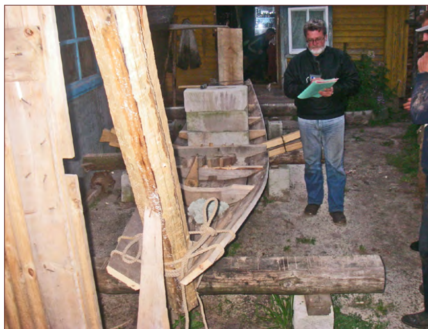
Илл. 3. Строительство новой лодки-«челнока» в д. Киршино. Загиб «днища» — килевой доски. Фото автора, 2008 г.
