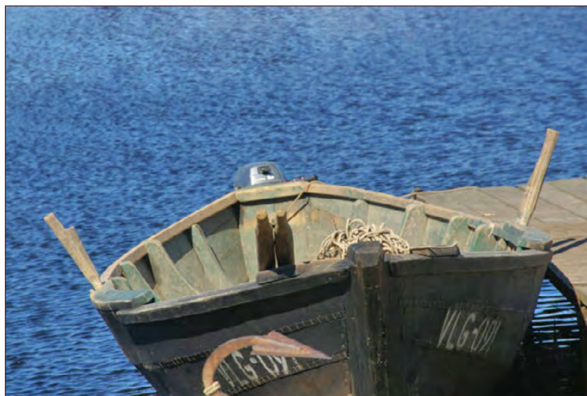
Илл. 30. Лодка «встык с ластом». Фото из архива Ф. Маспанова, г. Муствез, Эстония
