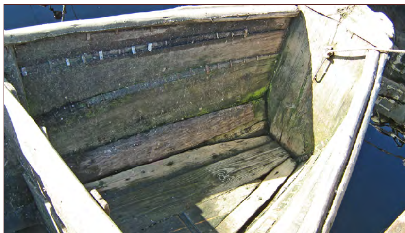
Илл. 6. Ластовое уплотнение с металлическими скобками. Фото автора, 2008 г.
