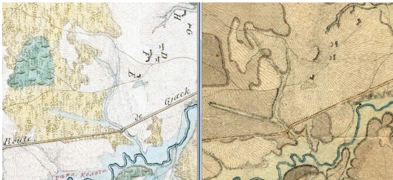
Рис. 114. Различия в качестве исполнения штриховки крутизны на ПШР-1815 и ПШР-1823 в районе укреплений Богарне.
