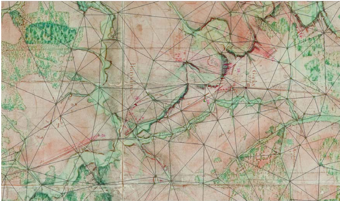
Рис. 146. Привязка к современной электронной основе изображения плана Пресса, Шверие, Реньо масштаба 1:14 400 по выбранным характерным точкам местности
