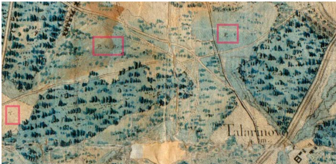
Рис. 65. Буквенные знаки, используемые для характеристики угодий. На рисунке видны буквы «Т.» (слева), «Р. v. Br» (в центре) и «Р.» (справа). Строчные леса показаны перспективным рисунком
