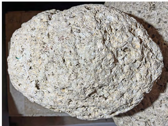
2. Кавернозность, структурная неоднородность
