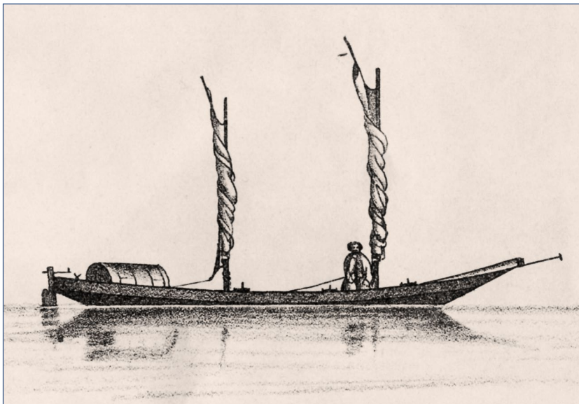
Рис. 30. Коснушка «на трубе», вооружённая двумя мачтами с шпринтовыми парусами 106
