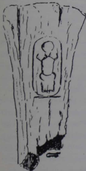
43. Деревянные крепления в форме „ласточкина хвоста“ из облицовки пирамиды Сенусерта I в Лиште.
