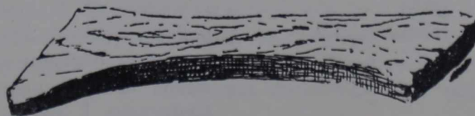
43. Деревянные крепления в форме „ласточкина хвоста“ из облицовки пирамиды Сенусерта I в Лиште.
