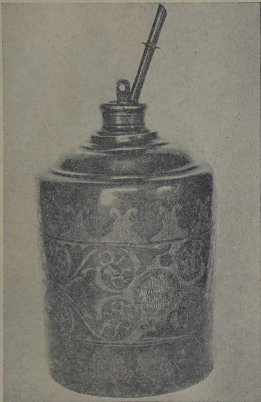
Рис. 1. Перегонный куб М. В. Ломоносова
