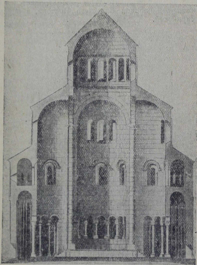
Рис. 6. Храм Гагикашен. Разрез (реконструкция арх. Тораманяна)
